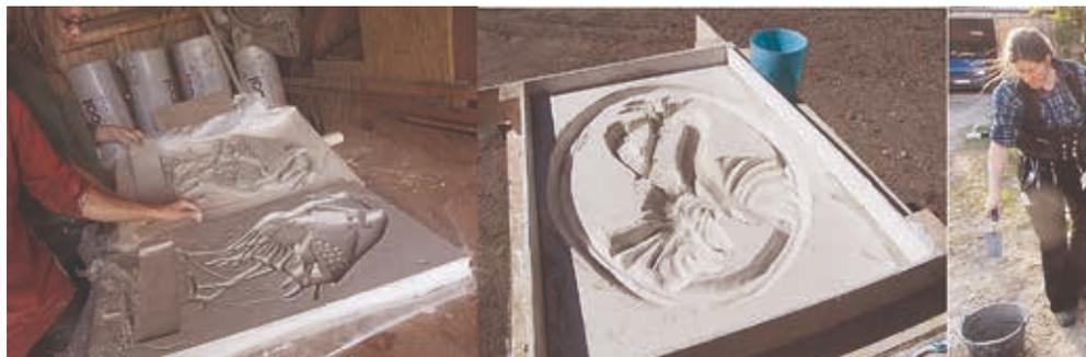
Abb. 9 (links) Positiv- und Negativform, (mitte) Nachbearbeitung der Form mit Entfernung von Überschneidungen, Glättung, Trennschicht und Verschluss von Ritzen, Guss auf waagerechter Platte
